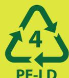
**ПВД** Полиэтилен высокого давления
